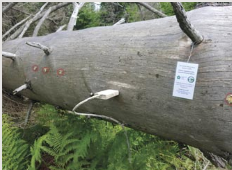
Vlhkostní čidlo umístěné v ležícím kmenu a díry po fyzických odběrech dřeva.
